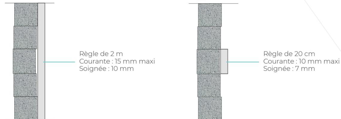
En cas de non-respect de ces critères, un enduit de dressage doit être réalisé. Attendre 4 jours avant l'application de l'enduit monocouche sur ce dernier.
