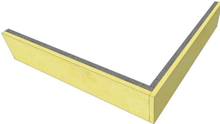
*Figure n°3a : Exemple de coupe d'angle à 90° sortant*
